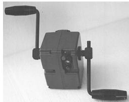
*Ручной привод может длительное время давать около 50 Вт. От педального привода в постоянном режиме в среднем можно получать около 125 Вт, или 1/6 л. с., в коротких рывках можно достигать максимум 350 Вт, а если вы используете маховик, то даже до 1500 Вт. Для больших нагрузок это неприменимо, если нет какого-нибудь аккумулятора или блока аккумуляторов.*
